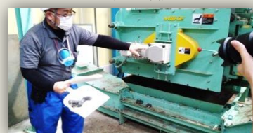
成形機より出てきた RPF(固形燃料)
